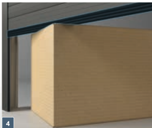
Krawędziowa listwa bezpieczeństwa – optyczne czujniki krawędziowej listwy bezpieczeństwa zamontowane są w dolnej uszczelce bramy. Brama po zetknięciu z przeszkodą zatrzymuje się i powraca do pozycji otwartej – standard dla bram Automatik.
